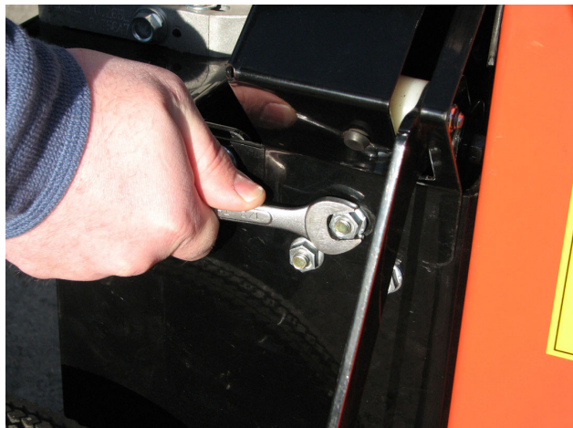
Figure 5.9, Dépose de la protection de la courroie
