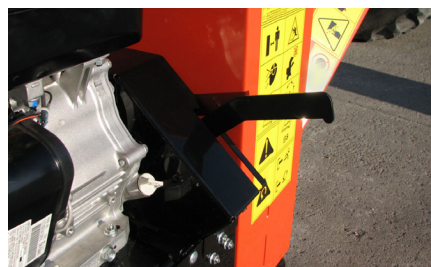
Figure 3.1, Déclenchement de la courroie de position de démarrage
