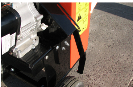
Figure 3.2, Position de fonctionnement de la courroie engagée
